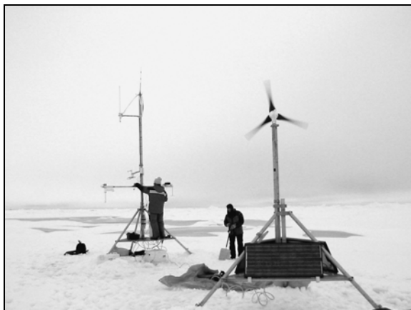
Figur 8. Uppsättningen av en PAM-station. Instrumenttripoden, med turbulensinstrument och instrument för temperatur, fuktighet, och tryck syns i bakgrunden; antennen på toppen ingår i radiomodemet som levererar data i realtid till Oden. Hela systemet drevs av batterier som kontinuerligt laddades från solpaneler och en vindgenerator på tripoden i den främre delen av bilden.
