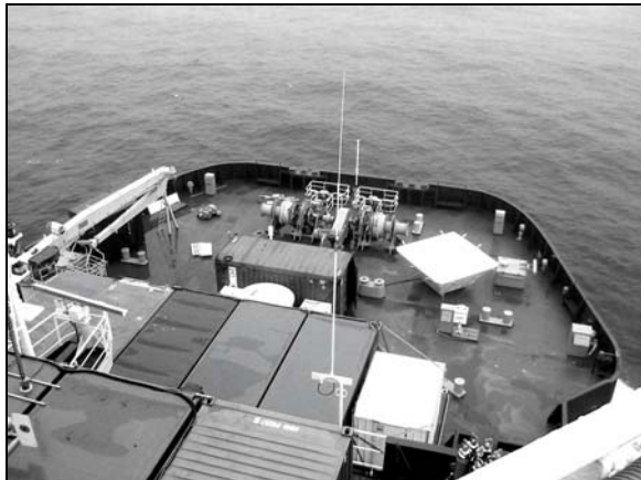
Figur 3. Vy över Oden's fördäck från det översta 7:de däck, med den fyrkantiga antennen till NOAA/ETL 915 MHz vindradar och den runda antennen för S-band molnradar, delvis skydd bakom den främre containern.
