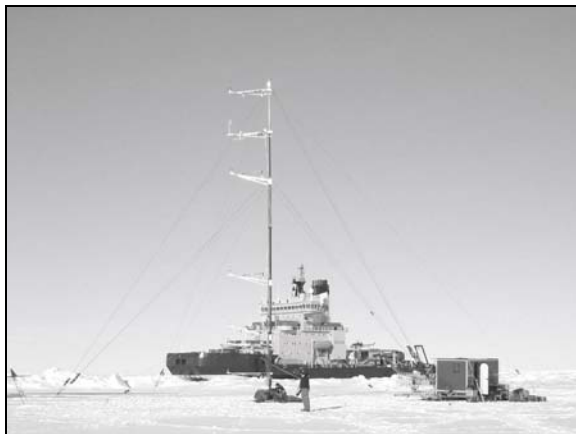
Figur 7. En 18 meter hög teleskopmast, instrumenterad med profil- och turbulensinstrument. Till höger ses hyddan för datorer och elektronik. Oden är ~300 m bort i bakgrunden.
