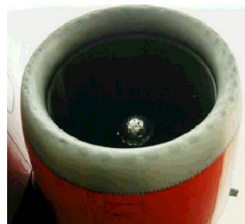
Fig. 6. Bucklor på luftintaget.
