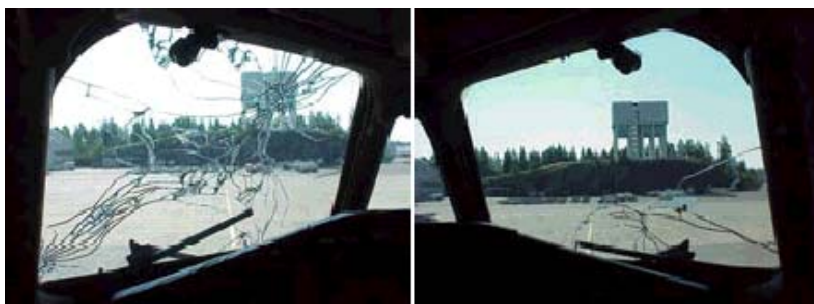
Fig. 5. Skador på vänster och höger yttre frontrutor. Bilder från Accident Investigation Board Finland.
