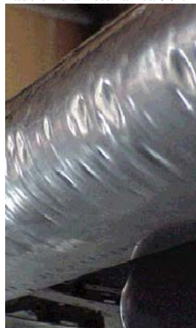
Fig. 2. Skadorna på radomen hade en diameter av ca 50 cm.
