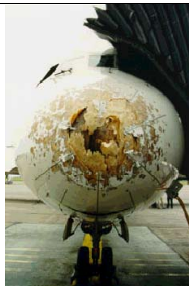
Fig. 2. Skadorna på radomen hade en diameter av ca 50 cm.
