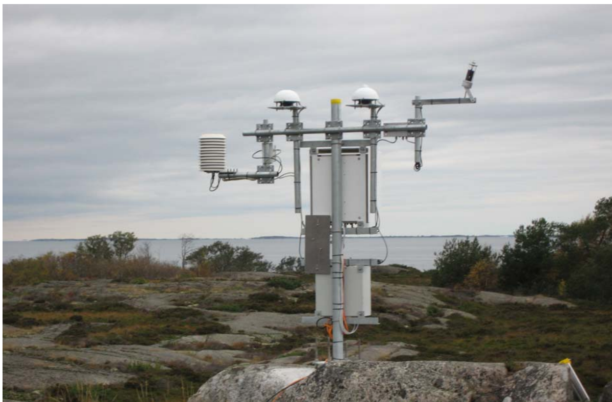
Enkel strålningsstation (med långvågsstrålning), Svenska Högarna.
