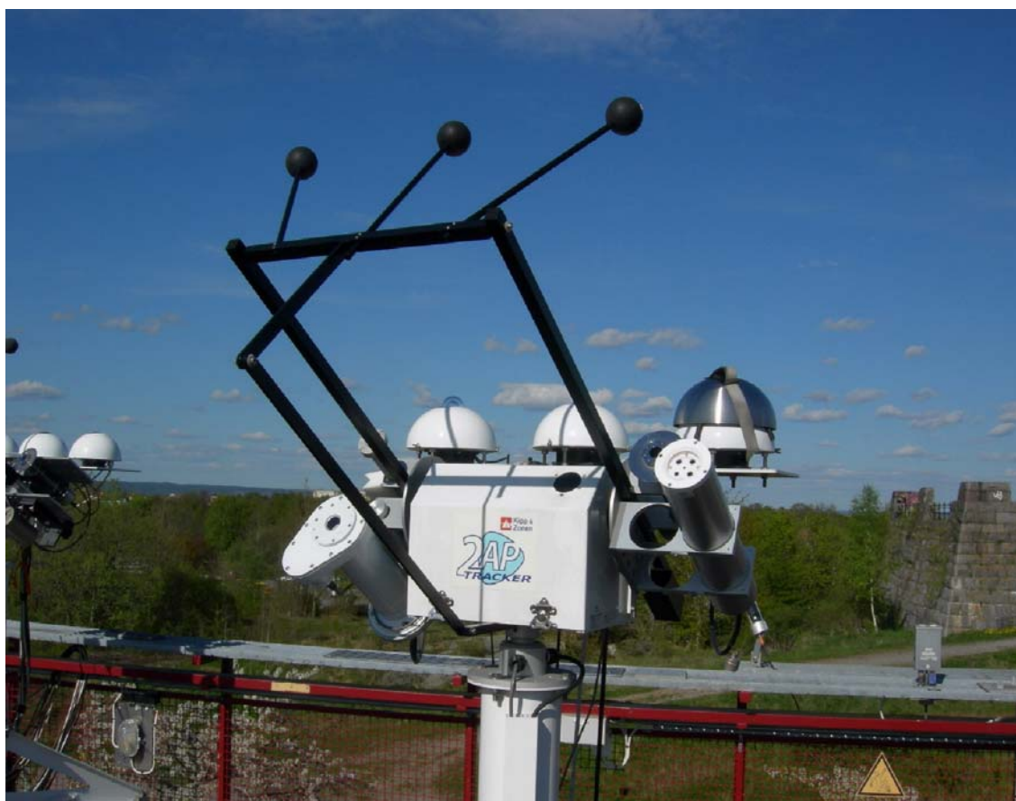
Solföljare med instrument som används på de avancerade mätstationerna. (Se artikel sid 17)
